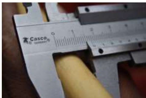
Midiendo 18 mm de espesor.
