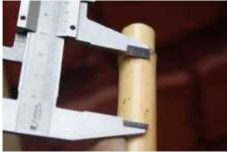
Midiendo 33 mm que tendrá el orificio
