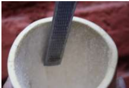
Puliendo el interior de la bocina.
