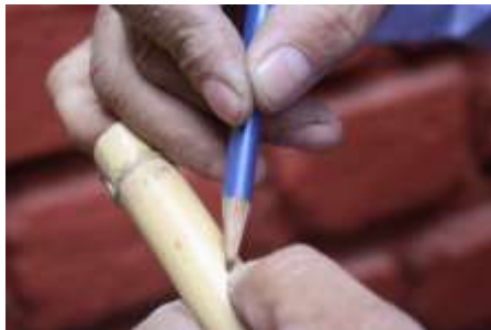
Marcando los 33 mm que tendrá el orificio
