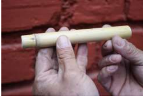
Boquilla lista para hacerle el orificio de bordes curvos.
